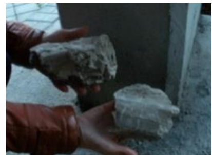
Desprendimiento paneles de fachada.
