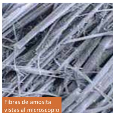
Material con amosita (60 X)
