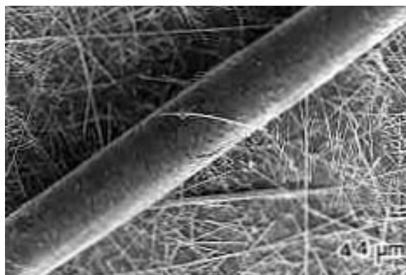
Comparación a través de microscopio de un cabello humano sobre fibras de amosita, amianto marrón de fibras rectas.
