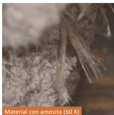
Material con amosita (60 X)
