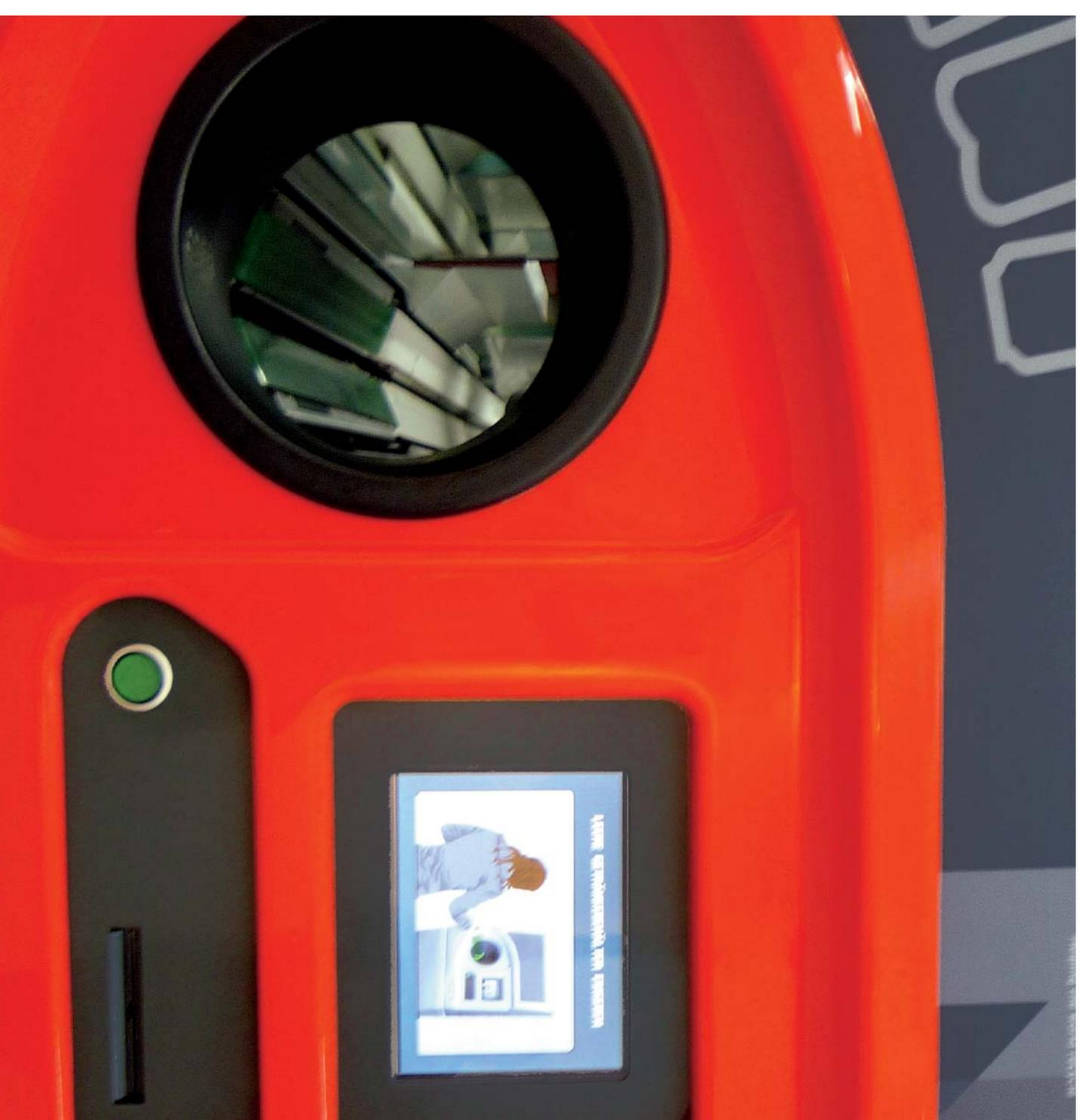
Máquina automática para devolver los envases en Alemania. A la izquierda la boca para introducir el envase, a la derecha el botón y la ranura para recoger el ticket con el importe. Foto: G. C. DEUS.
