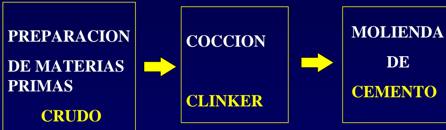
□ Proceso intensivo en el uso de energía. Necesidad de energía térmica para la “cocción” o “fusión” del clínker (90% de la energía total).
