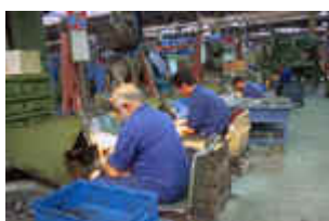
Operarios rebarbando impurezas. Usan fluidos de corte.
