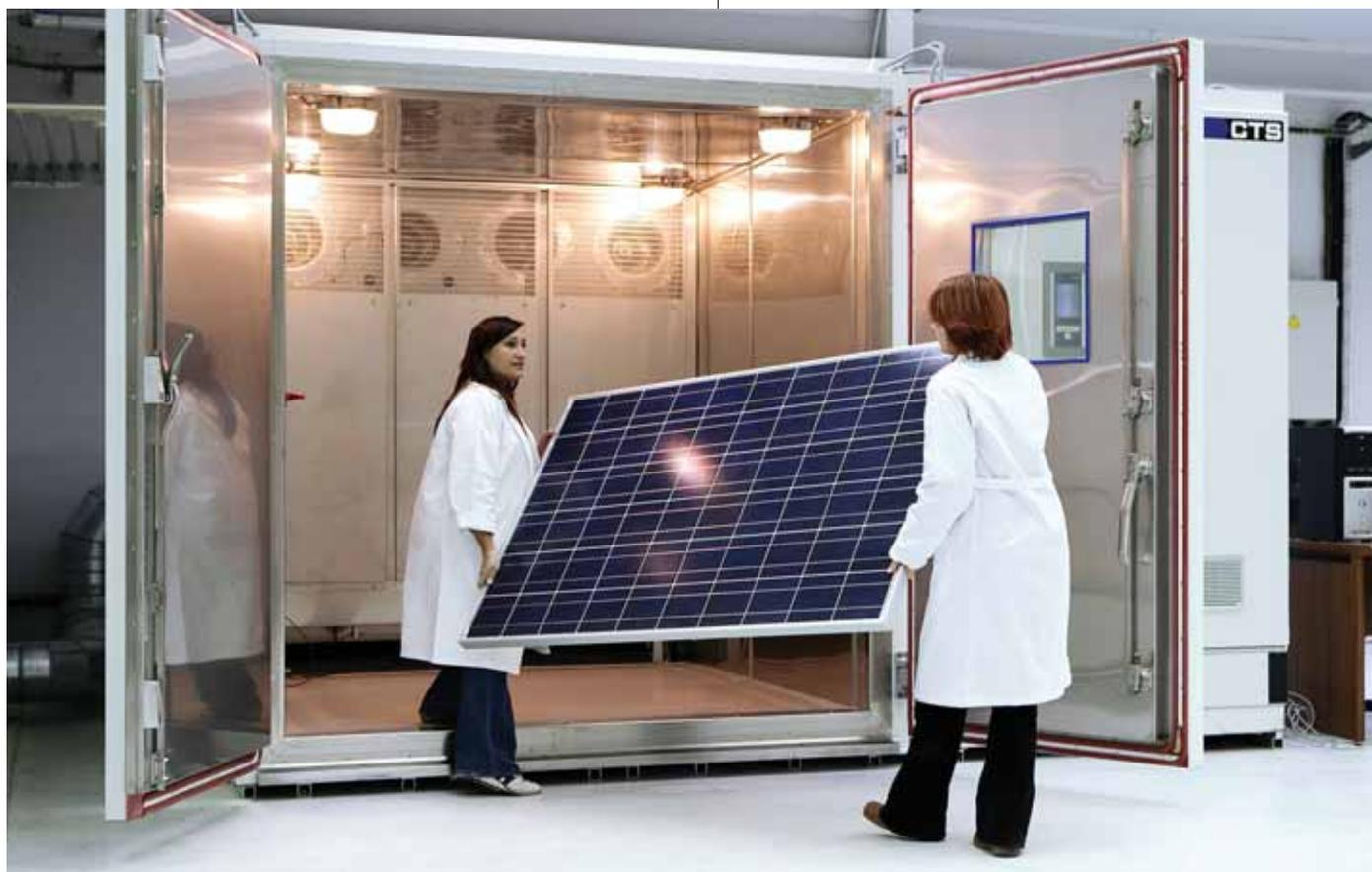
*Dos trabajadoras introducen un módulo fotovoltaico en una cámara climática para comprobar su resistencia.*
