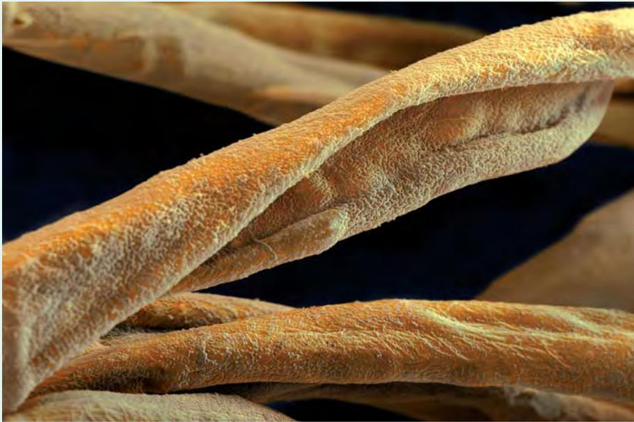
Fibras textiles con nanopartículas. Billones de pequeñas nanopartículas, midiendo menos de 100 nanómetros, proporcionan en las fibras un efecto de repelencia y "auto-limpieza" similar al que en la naturaleza tienen las hojas de la planta del loto, ya que materialmente las partículas de polvo no encuentran asiento entre ellas.
