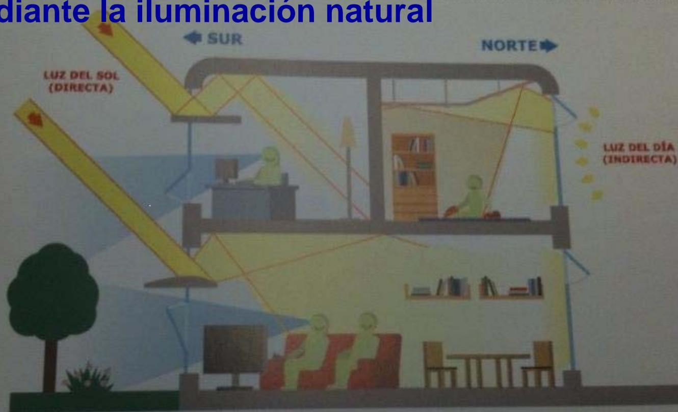
La introducción de repisas reflectantes en la orientación Sur del edificio, como de techos reflectantes en la orientación Norte, permite aprovechar la luz del sol en el interior de las viviendas.
