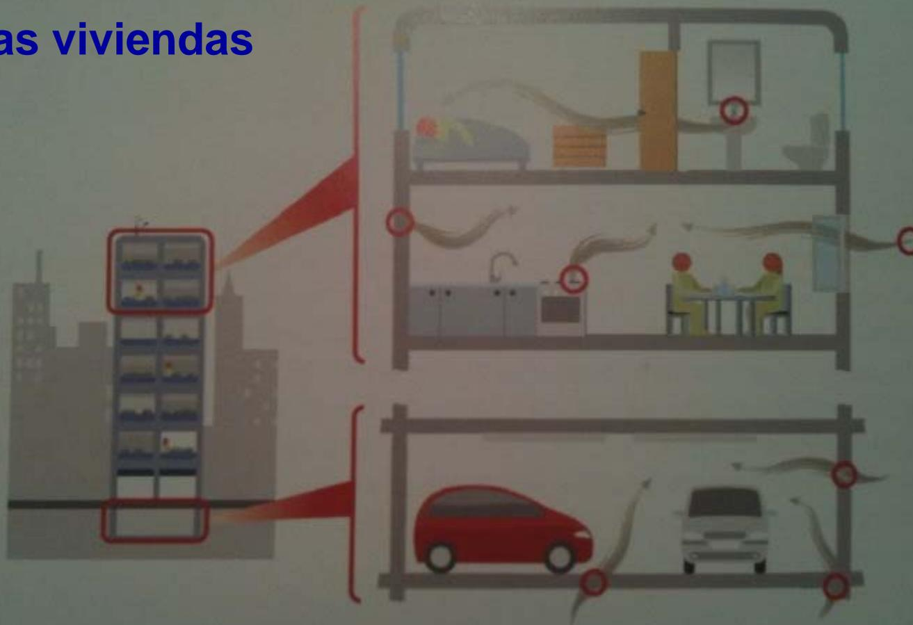
El gas radioactivo radón puede acumularse en el interior de las viviendas desde el subsuelo a través de grietas, el suministro de gas natural y agua de pozo, el ambiente exterior y los materiales de construcción.
