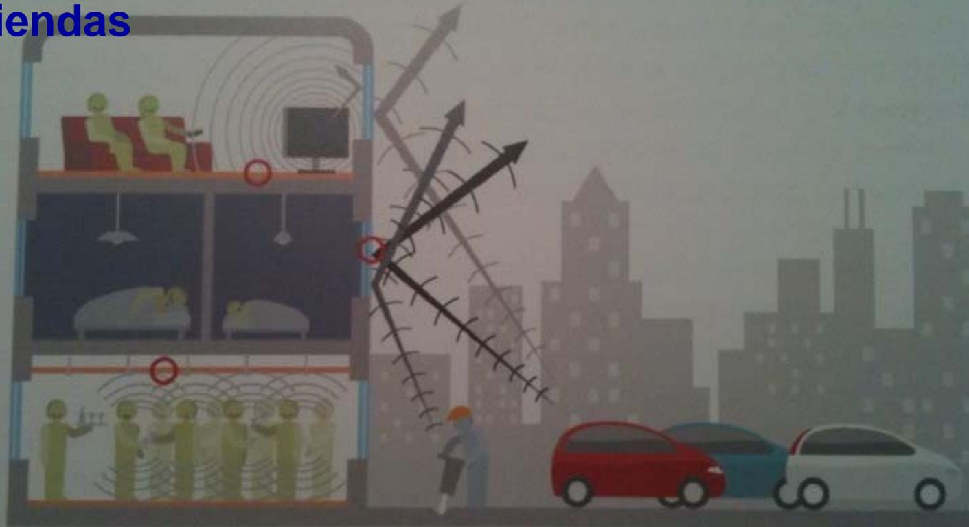
El uso de doble acristalamiento aislante al ruido exterior y el aislamiento acústico de paredes y techos evitará las molestias ocasionadas, tanto por actividades externas como internas en el edificio.
